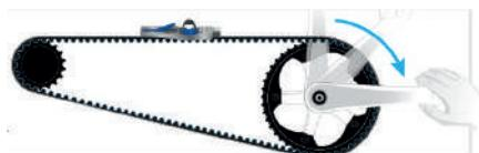
Die durchschnittliche Spannung muss zwischen 43 lbs (=19,5 kg) und 47 lbs (=21,3 kg) liegen.
