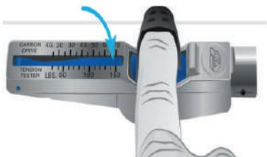
1. Überprüfen Sie, dass der Indikator komplett abgesenkt ist. Legen Sie den Zeigefinger auf das dafür vorgesehene Gummiband über der Sperrklinke (siehe Abbildung).
