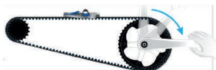
La tension moyenne mesurée doit être comprise entre 43lbs et 47lbs.
